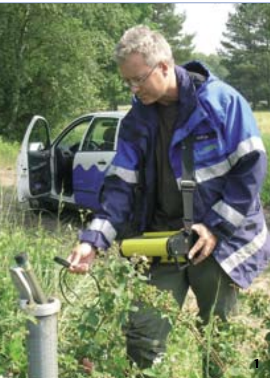
1 An einzelnen Messstellen lesen Mitarbeiter den Stand des Grundwassers ab. 2 Weniger ist mehr: Die Extensivierung der Flächennutzung schont das Grundwasser. 3 Um neue Brunnen für die Trinkwassergewinnung zu bauen, ist Fachwissen gefragt. 4 Gemeinsames Interesse am Grundwasser zeigen Ortsansässige und andere Interessierte zum Beispiel bei Touren im Grundwassergewinnungsgebiet Ristedt.
