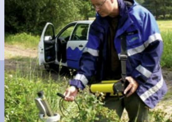
Messung des Grundwasserstandes
