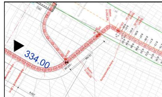
Setzplan der teilüberschnittenen Bohrpfahlwand (Auszug).
